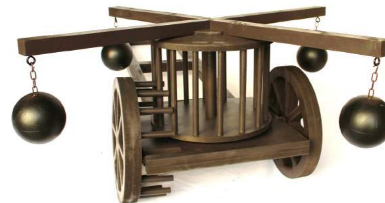
Faucheur à boulets Cette machine était tractée par des chevaux. En avançant, elle entraîne un grand engrenage central, muni de 4 poutres armées d'un boulet. En tournant à vive allure, ces boulets fauchaient les assaillants. Une fois de plus, De Vinci perfectionne une machine ancienne. À l'origine, le faucheur à lames provient de Plutarque qui raconte comment Alexandre le Grand a dû affronter les chars à faux de Darius. © Jean-Christophe Hubert
